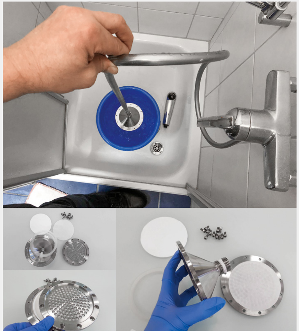
Fig. 1 Mehr Probenvolumen durch Filtrationsbeprobung vor Ort. Anstelle der Duschbrause wurde eine Membranfiltrationseinheit aufgeschraubt. Das Volumen des filtrierten Wassers wurde mit einem Messeimer bestimmt (angestrebt waren 50 l). Im Anschluss wurde die Filtermembran im Labor weiterverarbeitet.
